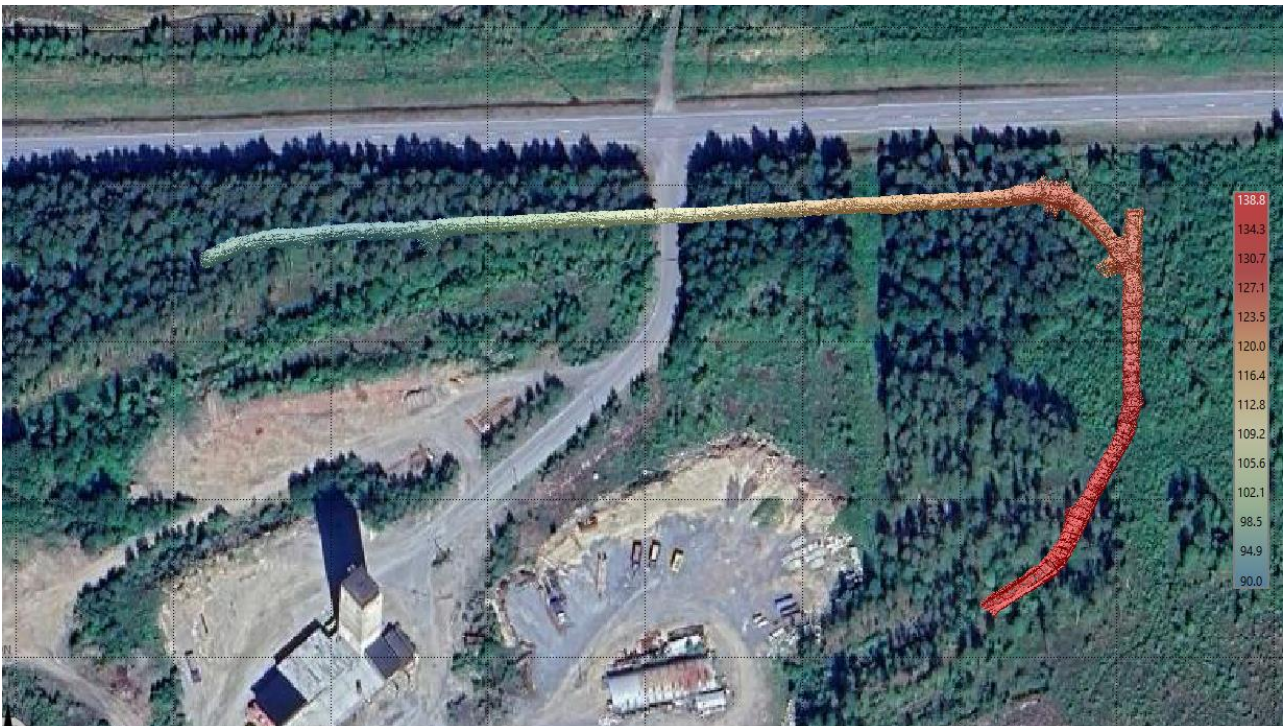
Kuva 27. Georeferoidun tunnelikäytävän skannaustulos. Tunnelin värisävy kuvaa sen syvyysijaintia. Kuvan oikeassa reunassa on väriselite esittää korkeusaseman metreinä.
