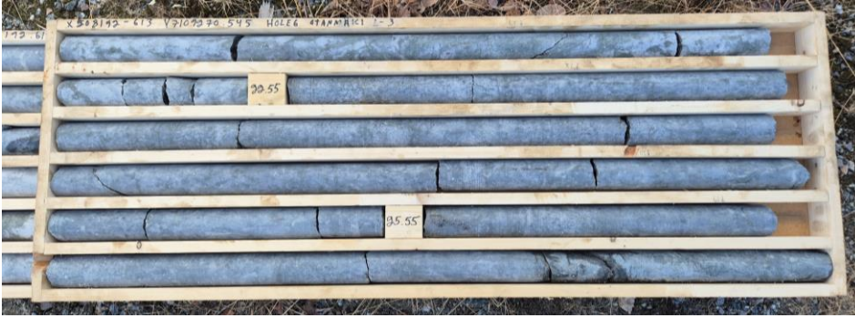
Kuva 24. Kairasydänlaatikko, reikä 26S06, kairasydän syvyysväliä 21–27 m.
