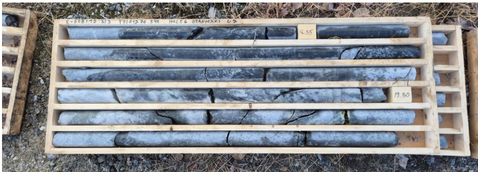
Kuva 23. Kairasydänlaatikko, reikä 26S06, kairasydän syvyysväliä 15–21 m.
