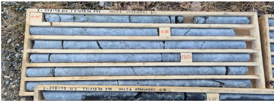
Kuva 22. Kairasydänlaatikko, reikä 26S06, kairasydän syvyysväliä 11–15 m.
