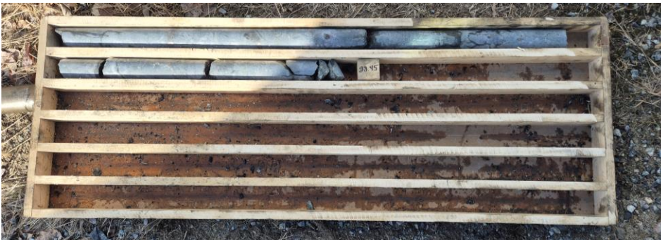
Kuva 25. Kairasydänlaatikko, reikä 26S06, kairasydän syvyysväliä 27–29 m.
